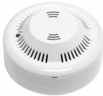
A série NB983 de detectores convencionais de Gás Natural é baseada no sensor Fígaro. O detector possui uma sirene de 70dB incorporada, podendo ser calibrado de acordo com as Normas UL ou EN54. É um dispositivo com qualidade superior para a detecção de gases tóxicos ou inflamáveis.
