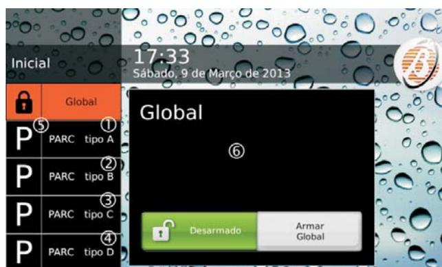
**Figura 28** Ativação com teclado Touch: as etiquetas 1, 2, 3 e 4 podem ser personalizadas, como explicado no texto; na posição 5 será indicada a letra inicial da Ativação Especial correspondente; na janela 6 aparece a descrição atribuída à ativação selecionada, como explicado no texto.
