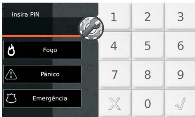
**Figura 26** Etiquetas de Fábrica das Super Teclas do Teclado Touch.
