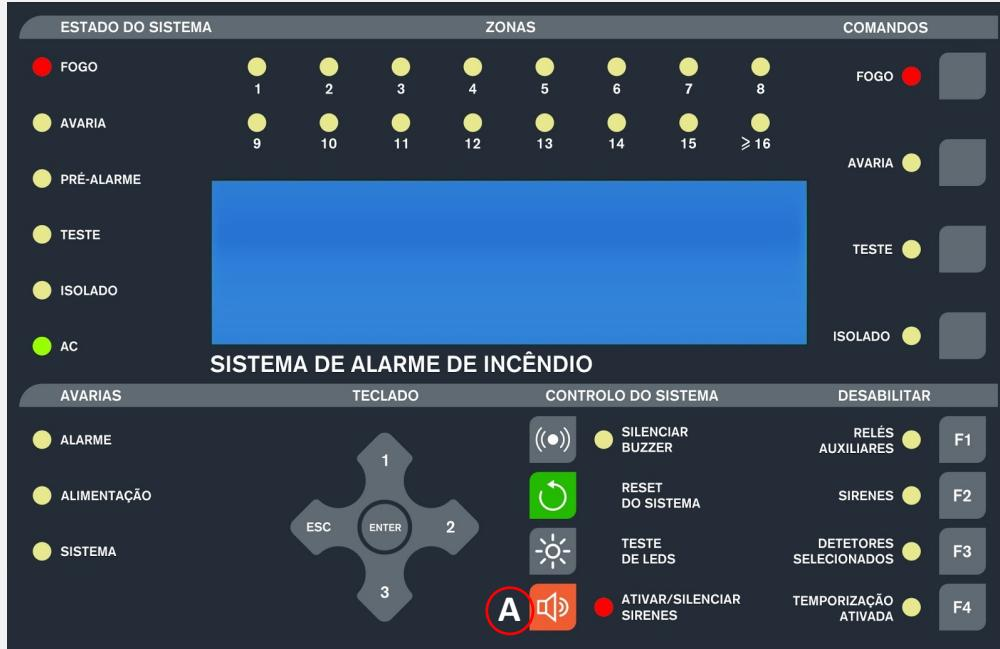
**A** Pressione e mantenha carregado o botão de TESTE DE LEDS.
