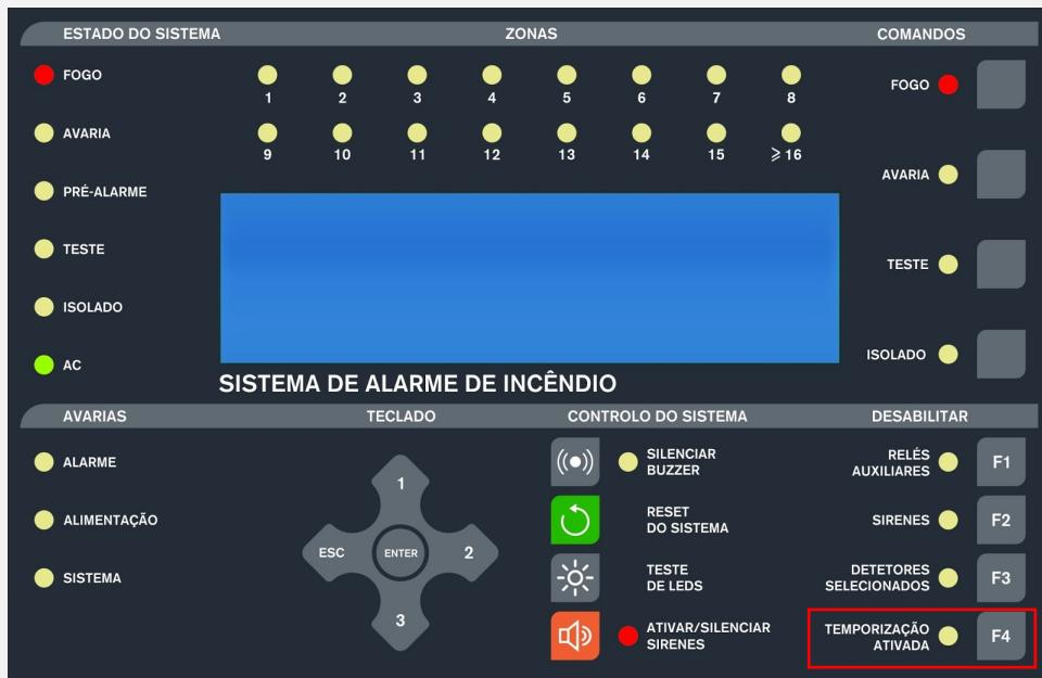
Durante a instalação através das funções de programação, temporizações podem ser programadas para as sirenes e/ou saídas de relés.
