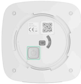
Para que a deteção e o emparelhamento aconteçam, o dispositivo deve estar dentro da área de cobertura da rede sem fios do hub (dentro de um único local protegido). Se o dispositivo já tiver sido atribuído a outro hub, desligue a HomeSiren e, em seguida, execute o procedimento de adição padrão.
