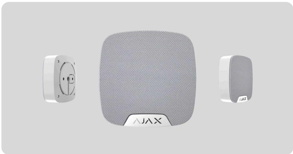
A **HomeSiren Jeweller** é uma sirene doméstica sem fios com capacidade até 100 dB. Desenvolvida apenas para utilização em interiores. Pode ser instalada e configurada rapidamente, vem equipada com um LED (além de permitir a conexão de um LED externo) e pode funcionar até 5 anos com uma bateria.
