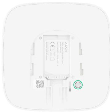
Para que a deteção e a interface ocorram, o ReX Jeweller deve estar localizado dentro do alcance de comunicação rádio do hub (na mesma instalação protegida).
