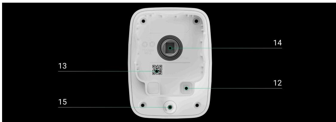
12. Botão de tamper. Reage à remoção do atuador elétrico do suporte.
