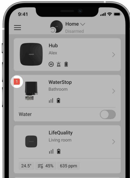
Se for detetada uma avaria no Ajax WaterStop (por exemplo, não há ligação com o hub ou o repetidor), o contador de avarias é apresentado no campo do dispositivo na app Ajax.
