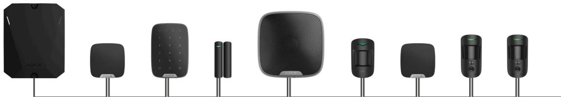
**A ligação em Anel** utiliza duas saídas de linha do hub. Se o anel se partir num único local, nenhum dispositivo será desativado. O anel reconfigura-se em duas linhas, que continuam a funcionar normalmente. Os utilizadores e a empresa de segurança receberão uma notificação sobre a rotura.
