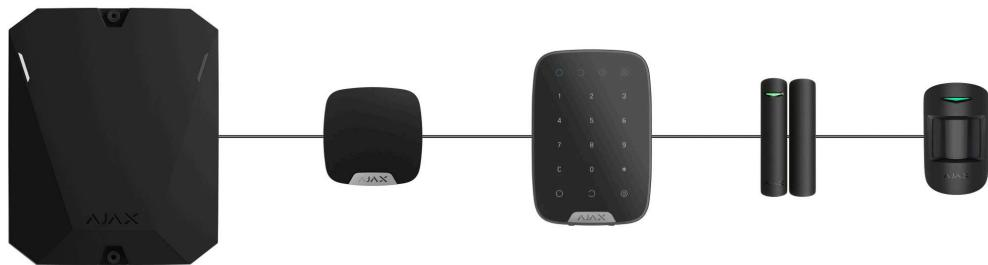
Quando utilizar a **topologia por Feixe (Radial)**, certifique-se de instalar um resistor de terminação de 120 Ohm na extremidade da linha (incluído no conjunto completo do hub). A resistência de terminação é ligada aos terminais de sinal do último detetor da linha.
