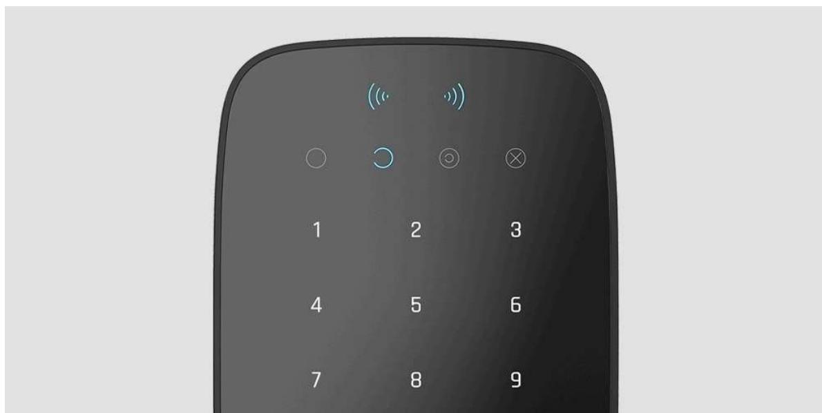
Pode utilizar o KeyPad Plus Jeweller sem iluminação ambiente, uma vez que o teclado possui retroiluminação. Ao premir as teclas, é emitido um sinal sonoro. A luminosidade da retroiluminação e o volume do teclado podem ser ajustados nas definições. Se não tocar no teclado durante 4 segundos, o KeyPad Plus Jeweller reduz a luminosidade da retroiluminação e, 8 segundos depois, entra no modo de poupança de energia e desliga o visor.
