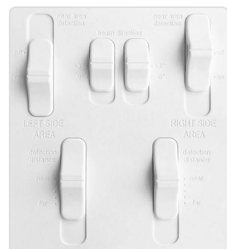
**Cada um dos lados** do DualCurtain Outdoor permite ajustar a distância e a direção da zona de deteção. Ajudam a ajustar o detetor consoante a arquitetura e asseguram uma deteção precisa das ameaças.
