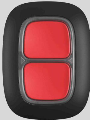
**DoubleButton** é um dispositivo sem fios com proteção avançada contra pressões accidentais. O dispositivo comunica com um hub através do protocolo de rádio encriptado Jeweller e é compatível apenas com o sistema Ajax. O alcance da comunicação em linha de vista é de até 1300 metros. O DoubleButton funciona com a pilha pré-instalada até 5 anos.
