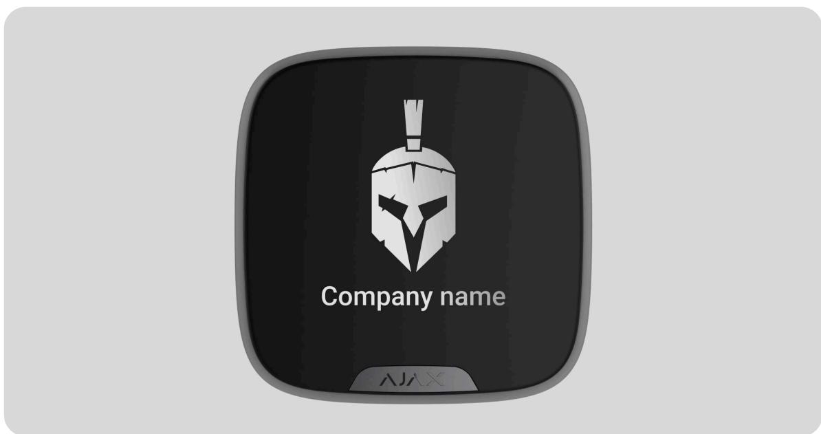
**StreetSiren DoubleDeck Jeweller** é uma sirene exterior sem fios com suporte para a tampa personalizável de marca. Equipada com uma moldura LED e um indicador de alarme piezoelétrico que produz um volume de som até 113 dB, a StreetSiren DoubleDeck Jeweller pode funcionar até 5 anos com as baterias pré-instaladas. Também pode ser alimentada por uma fonte de alimentação externa de 12 V.
