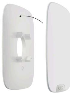
**10.** Fixe a Brandplate ao painel de plástico protetor usando o parafuso incluído.
