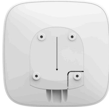
2. Ligue os cabos de alimentação e Ethernet às sockets adequadas e instale os cartões SIM.
