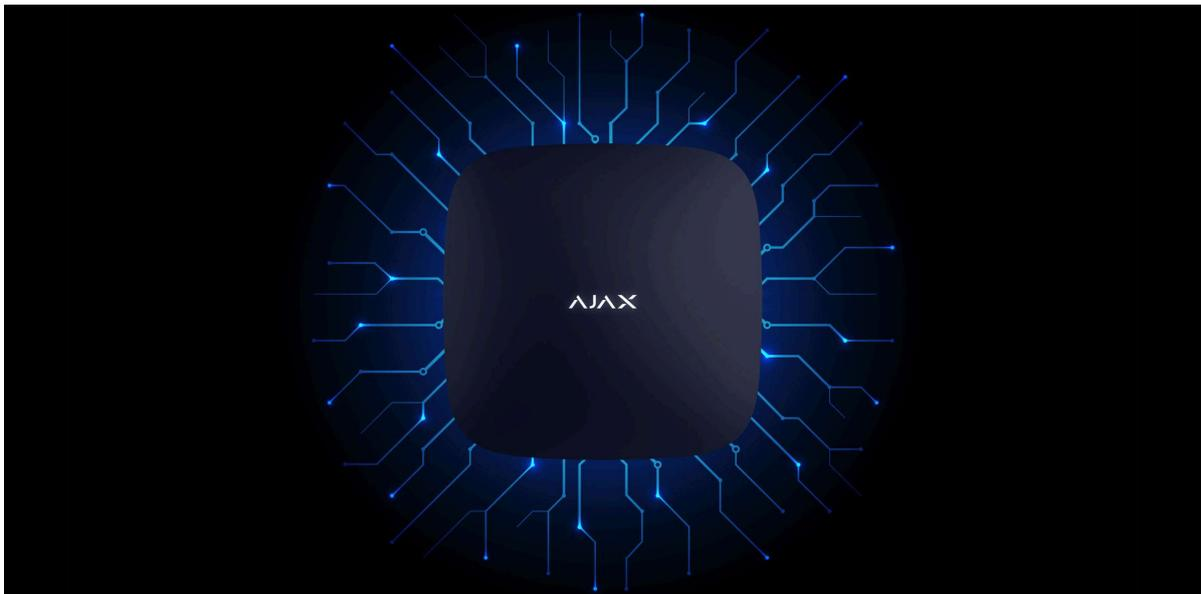
O Hub 2 tem três canais de comunicação: Ethernet e dois cartões SIM. Isto permite ligar o sistema à Ethernet e a duas redes móveis. O hub está disponível em duas versões: com modem 2G e 2G/3G/4G (LTE).
