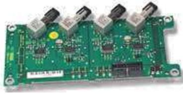
**Interfaz para conexión en red ID2net de fibra óptica**
