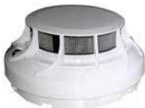
Detector óptico de humo color blanco con cámara IR. Sensor sensible y estable de rápida respuesta que se adapta al ambiente. Incorpora funciones de test manual y automático y direccionamiento decádico (01-159). Dispone de dos leds para la indicación de alarma y salida para indicador remoto. Para uso exclusivo con centrales AM-8200.
