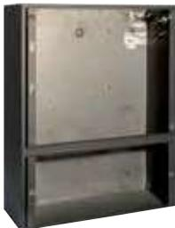
Cabina metálica de 2 cuerpos únicamente para centrales ID3000 con capacidad para ubicar el equipo básico 020-538-001, configurado para 2 u 8 lazos con fuente de alimentación de 3 a 4,5A integrada en la propia cabina y con espacio adicional para instalar la impresora 020-708-009 o baterías. Capacidad para albergar 2 baterías de 12Vcc 26Ah.
