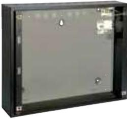
Cabina metálica estándar únicamente para centrales ID3000 con capacidad para ubicar el equipo básico 020-538-001, configurado para un máximo de 4 lazos y fuente de alimentación de 3 A integrada, o bien para un máximo de 8 lazos con fuente de alimentación de 7 A alojada en cabina independiente. Capacidad para albergar 2 baterías de 12Vcc, hasta 12Ah.
